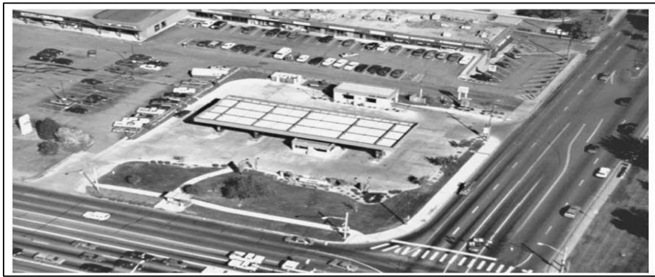
الشكل رقم (٩) يبين محطة وقود مع مداخل بعيدة عن التقاطع
