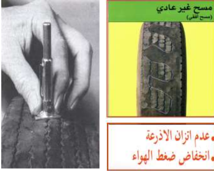
الشكل (١١) كيفية قياس عمق الفرزة بواسطة الكليب
