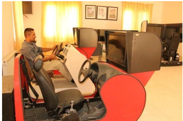
جهاز القيادة التشبيهية (سيموليتري) للشاحنات والحافلات
