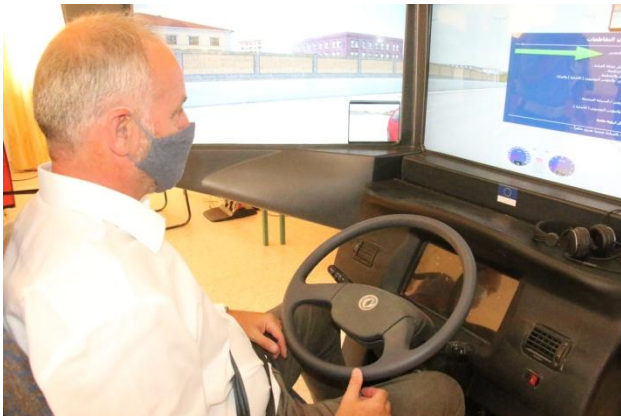
جهاز القيادة التشبيهية (سيموليتري) للشاحنات والحافلات
