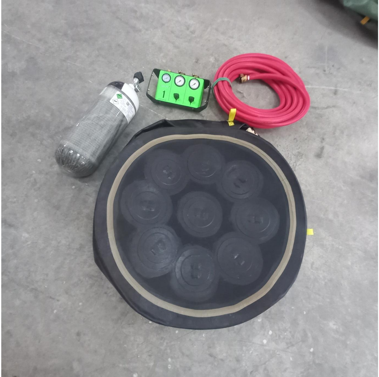
كت اكياس هوائية للرفع تستخدم لرفع الاوزان العالية والكتل الاسمنتية اثناء عمليات البحث والانقاذ العمراني
