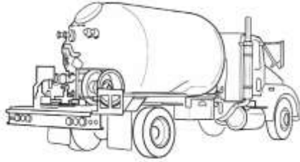
الشكل رقم (٥) يبين صهريج لنقل حمولة سائلة مثل النفط أو سائبة مثل الإسمنت أو غازية.
