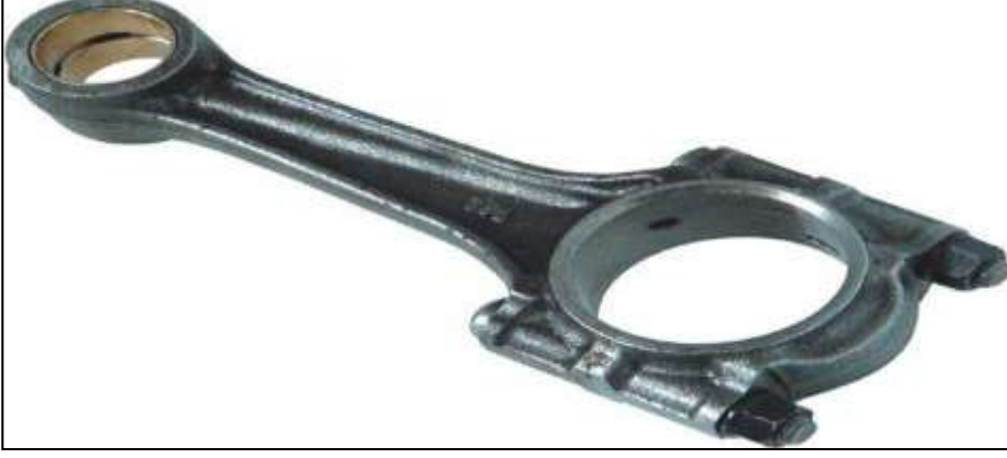
الشكل رقم (٩) يبين ذراع التوصيل مع سبيكة النهاية الكبرى
