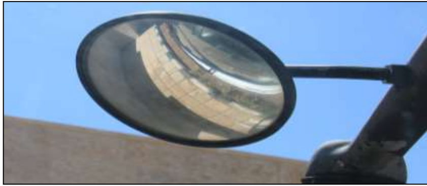
الشكل رقم (٢) ضبط المرآة الجانبية الثانية على الذراع بحيث تمكن السائق من مشاهدة جسم المركبة من الأمام واكبر مساحة ممكنة من الطريق من الأمام أيضاً.
