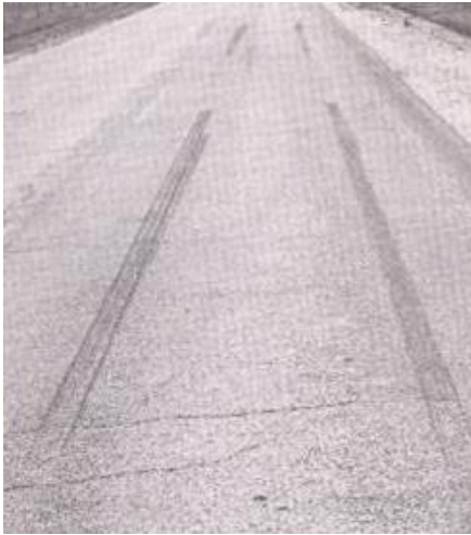
علامتي إنزلاق مفصولتان بفجوة ناتجة عن سلوك السائق برفع قدمه عن دواسة الفرامل عند الفجوة (تقاس العلامة كاملة مع الفجوة)
