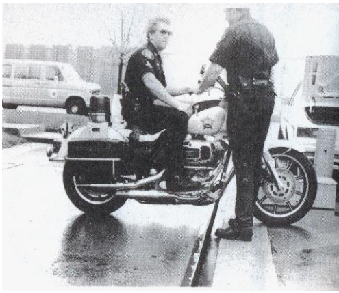
الشكل رقم (٣) يبين الوزن على المحور الخلفي عندما تكون الدرجة مستوية مع وجود سائق الدراجة.
