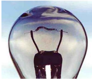
شكل رقم (١١-ج) الزجاج المعتم للمبة محترقة
