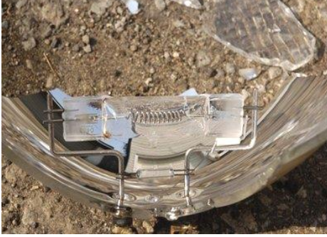
الشكل رقم (٣١) ضوء تعرض لصدمة باردة
