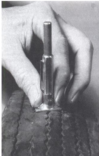
الشكل (١١) كيفية قياس عمق الفرزة بواسطة الكليب
