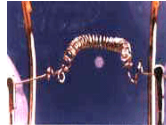
شكل رقم (١١-أ) اللمان المتلائي للشعيرة للمبة محترقة
