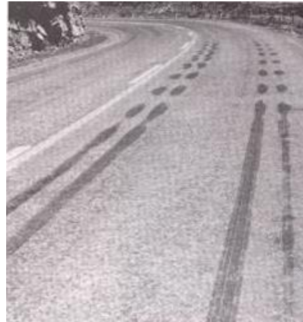
علامتي إنزلاق ناتجة عن إطارات مزدوجة لمركبة شحن محملة بحمل خفيف (دبذبة الإطارات أثناء الفرملة) تقاس العلامة كاملة مع الفجوات.
